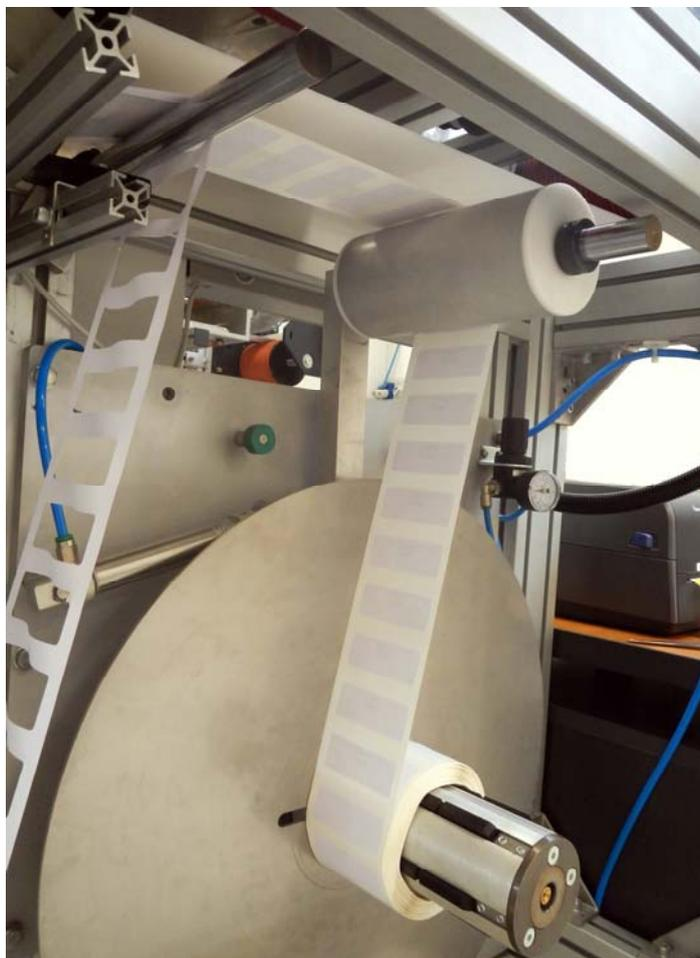
per realizzarla pure. Una macchina sviluppata integralmente all'interno, proprio per arrivare senza compromessi al prodotto che avevamo in mente: trasformare una normale etichetta autoadesiva in un'etichetta intelligente aggiungendo semplicemente 5 milligrammi di materiale abbattendo i costi di produzione e semplificando il processo produttivo".
